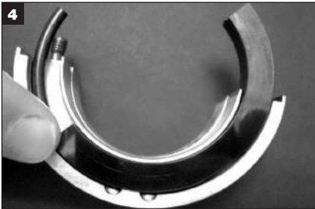
4 Avlägsna den roterande ytans förbrukade halvor genom att trycka i änden på ytan och dra ut den ur den roterande hållarens halva.
