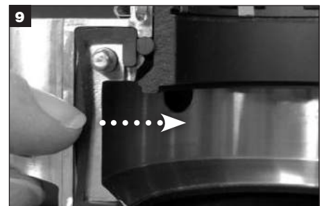
9 Avlägsna förbrukade glandpackningar från spårerna i glanden.
